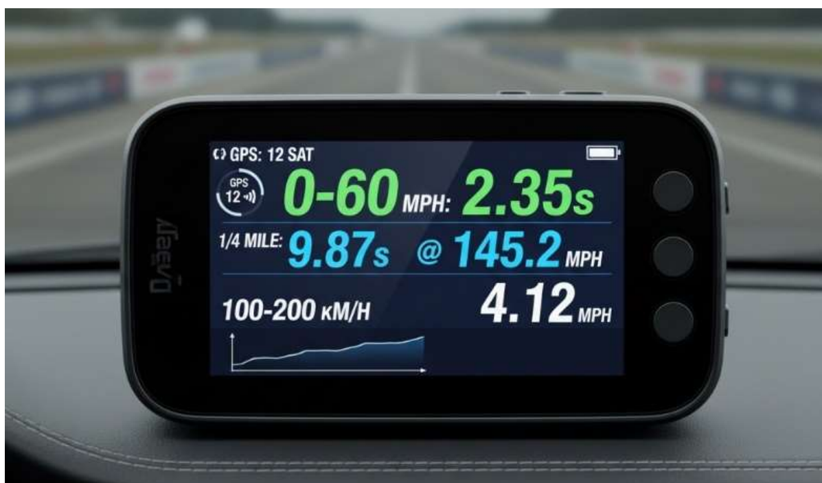
Рисунок 1.8 – GPS-основана система телеметрії Dragy
