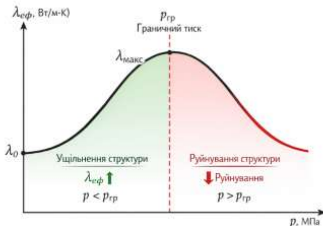
Рис. 1. Залежність ефективного коефіцієнта теплопровідності харчової сировини від надлишкового тиску:
