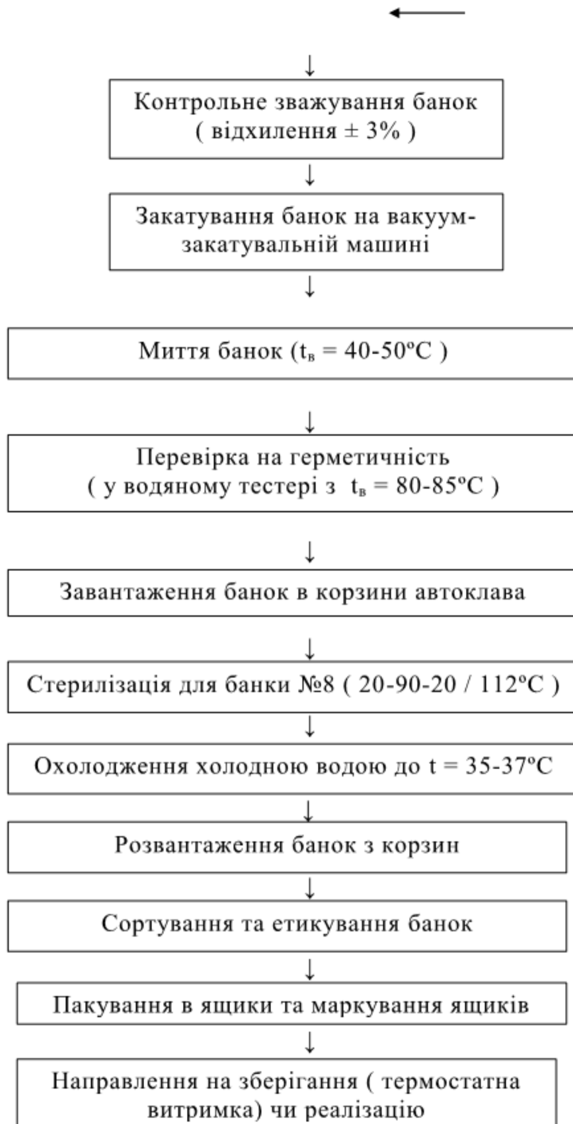
Рис.1.1 ТЕХНОЛОГІЧНА СХЕМА ВИРОБНИЦТВА ПАШТЕТУ «ЛЬВІВСЬКИЙ»
