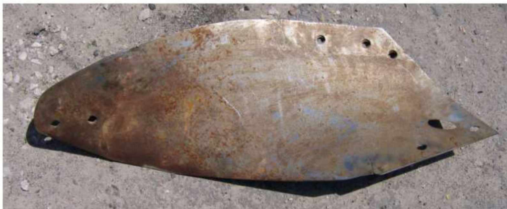
Рис. 1.4 – Наскрізне зношування площини відвалу плуга Gregoire Besson
