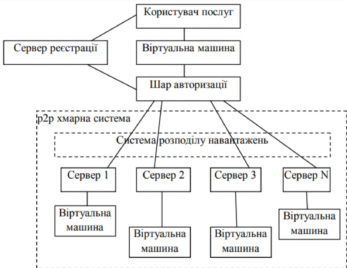
Рисунок 2.2 – Комплексна схема архітектури p2p хмарної системи [29]
