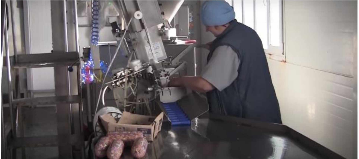
Рис. 3.4. Наповнення оболонок фаршу
