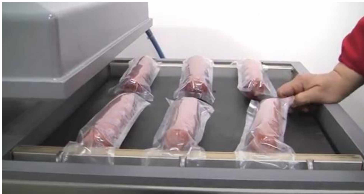
Рис. 3.6. Вакумування ковбасних батонів
