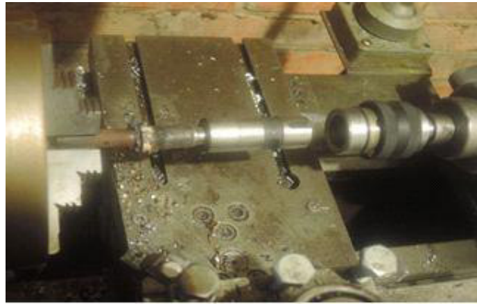
Рис.1. Деталь, зварена методом тертя на токарному верстаті за допомогою швидкозмінного патрона
