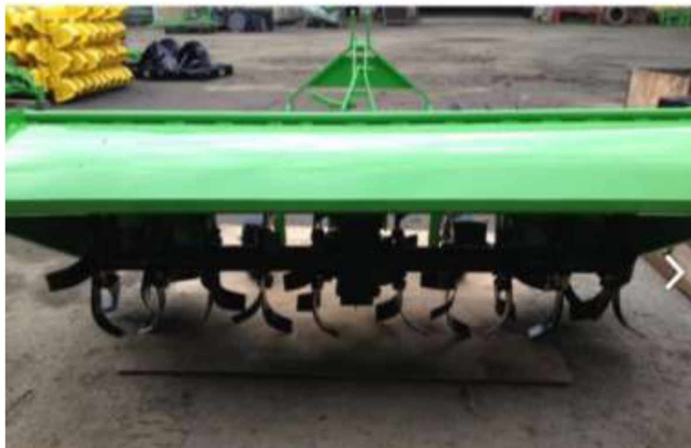
Рисунок. 1.2 – Фреза ФП-1,8 для суцільного обробітку ґрунту
