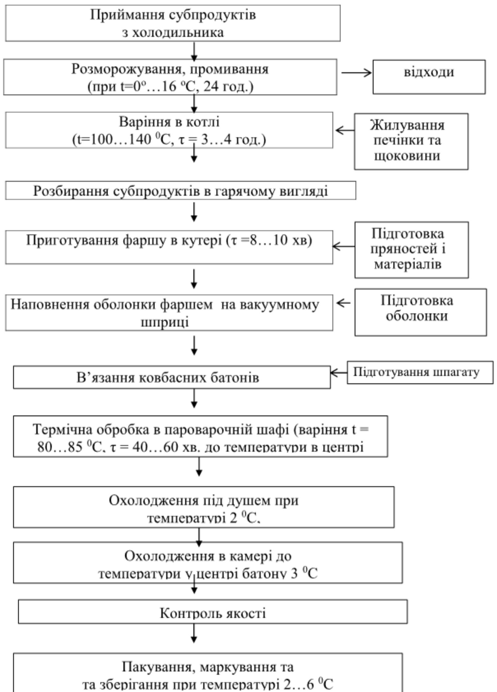
Рисунок 1.2.4- Технологічна схема виробництва ліверних ковбас, гарячий спосіб
