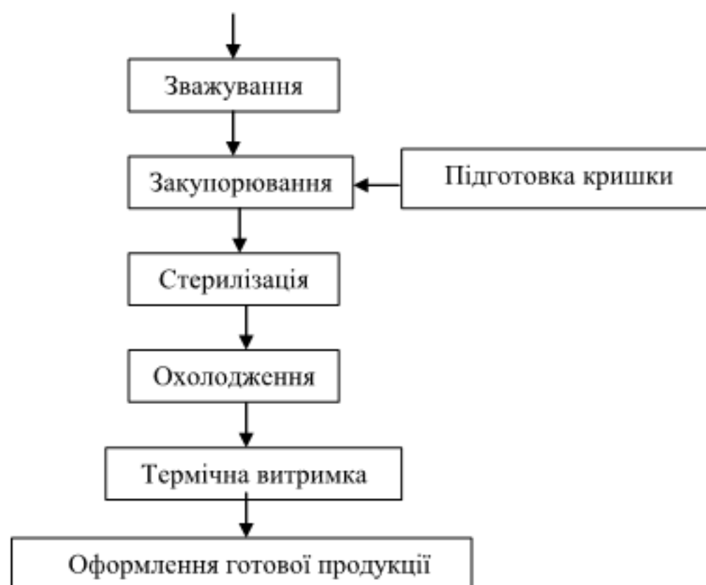
Рисунок 1.1 - Технологічна схема виробництва гомогенізованих консервів
