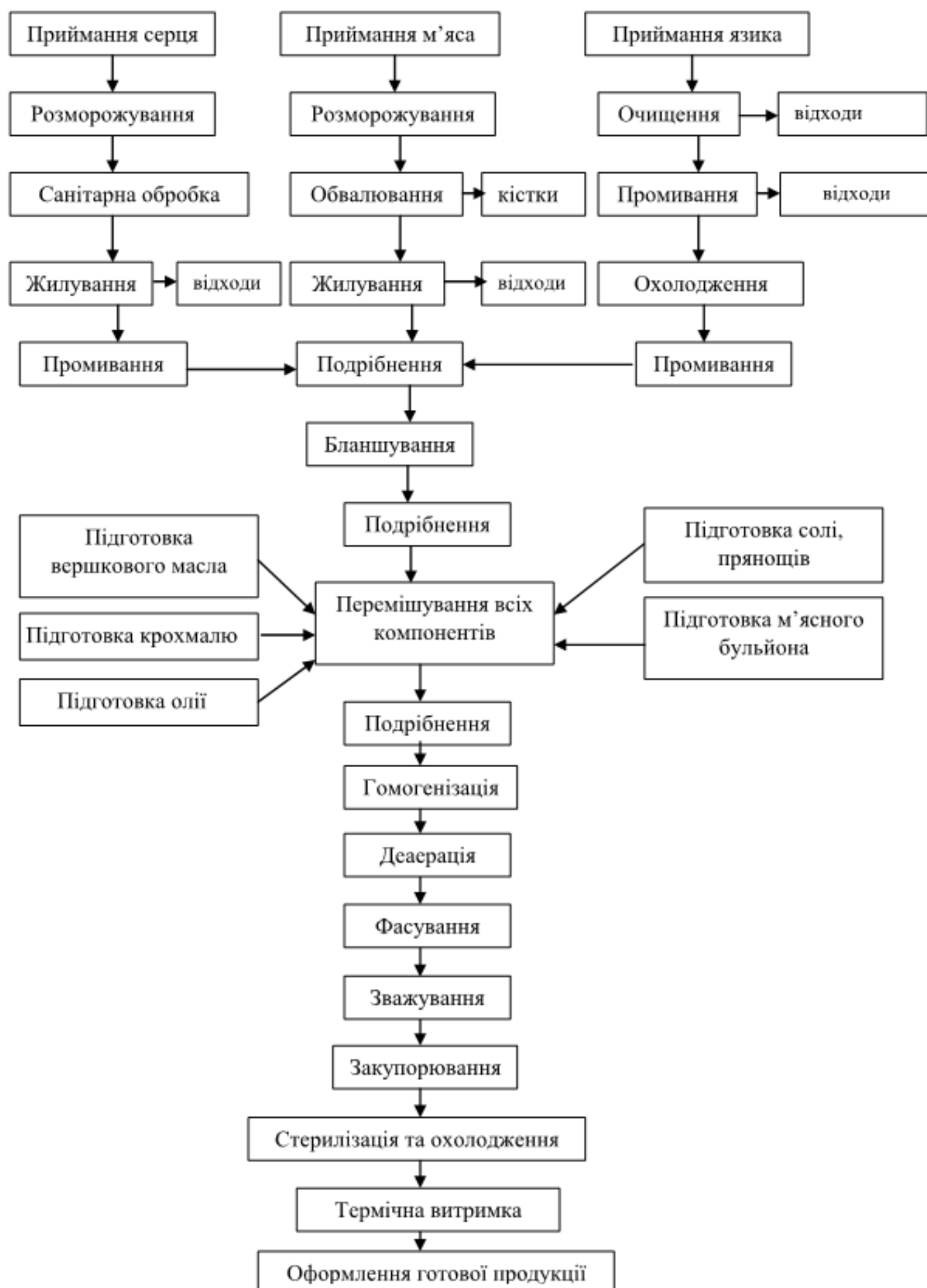
Рисунок А.1 - Технологічна схема виробництва м'ясного пюре для дитячого харчування
