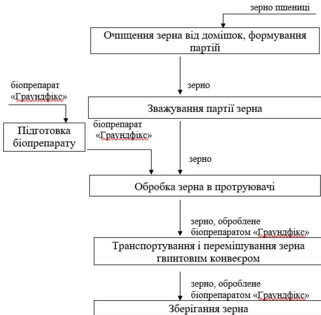
Рис. 3.12. Схема обробки насіння пшениці біопрепаратом Граундфікс
