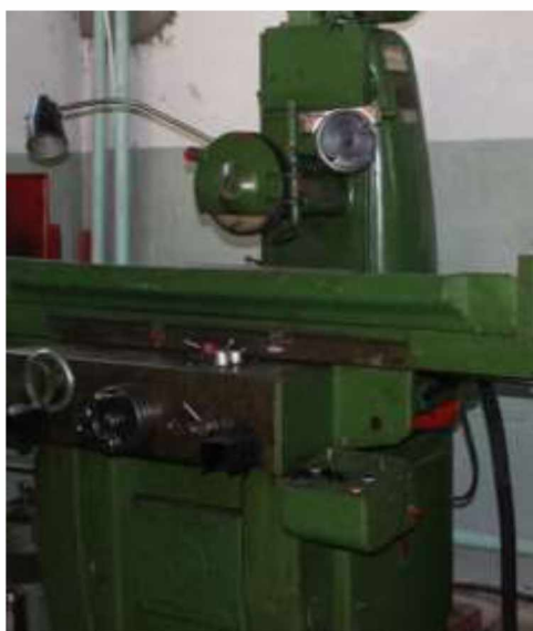
Рисунок 2.4 – Плоскошліфувальний верстат для обробки торців корпусів форсунок
