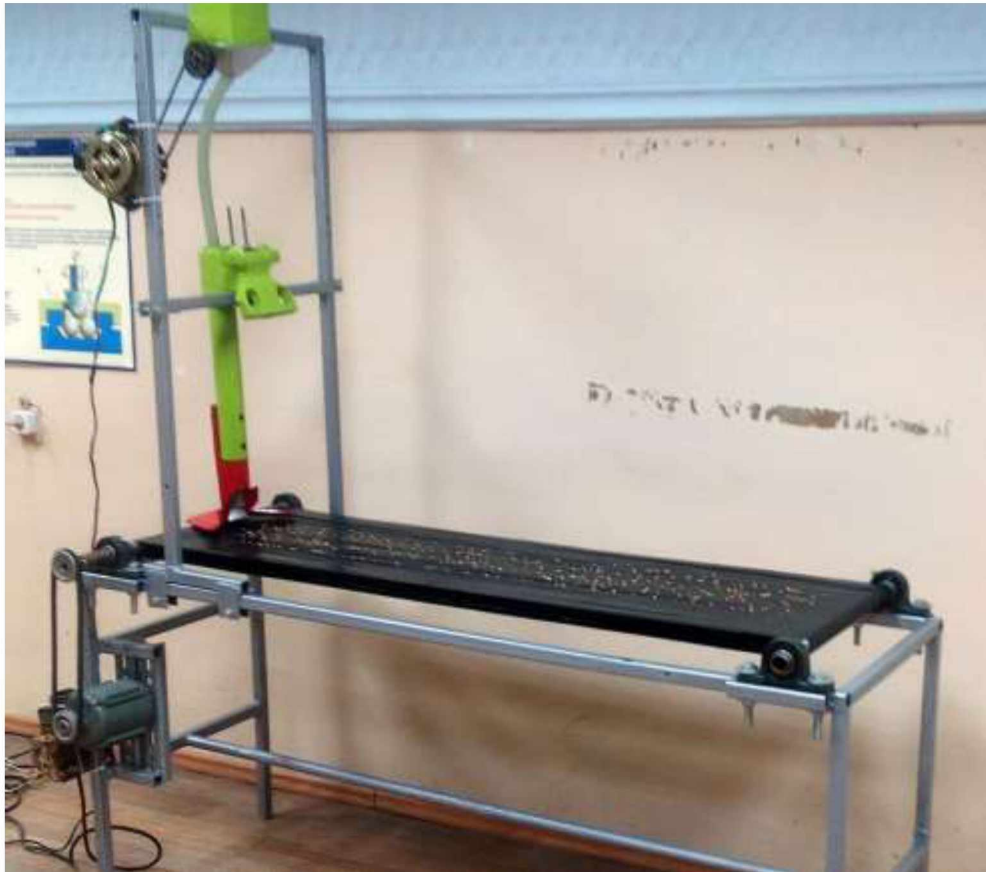
Рисунок 2.4 – Загальний вигляд лабораторної установки для оцінки ширини і рівномірності розподілу посівного матеріалу
