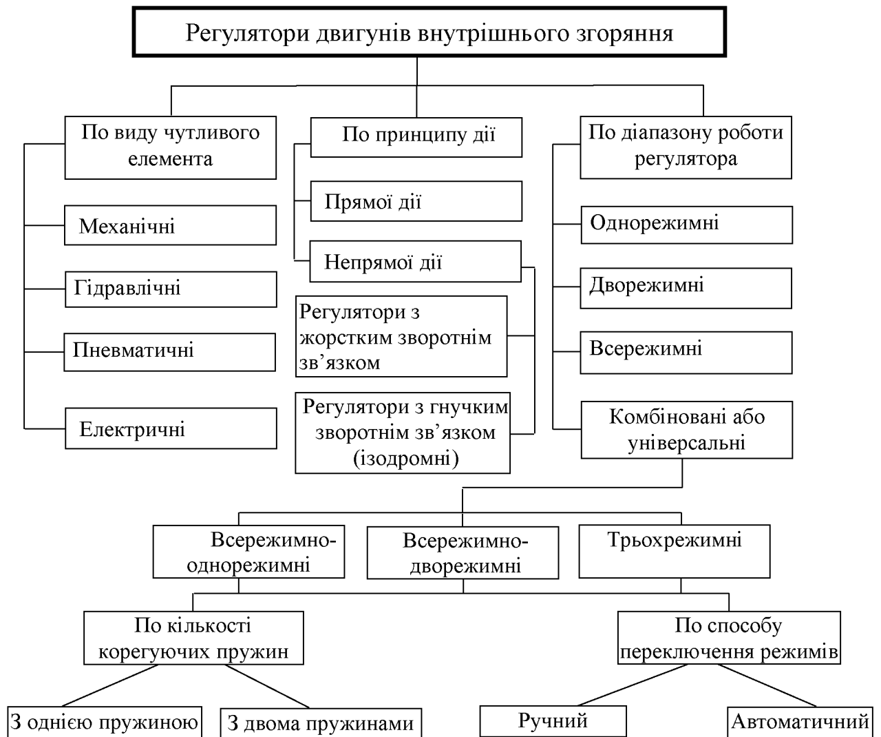
Рисунок 1.3 – Класифікація регуляторів двигунів внутрішнього згорання
