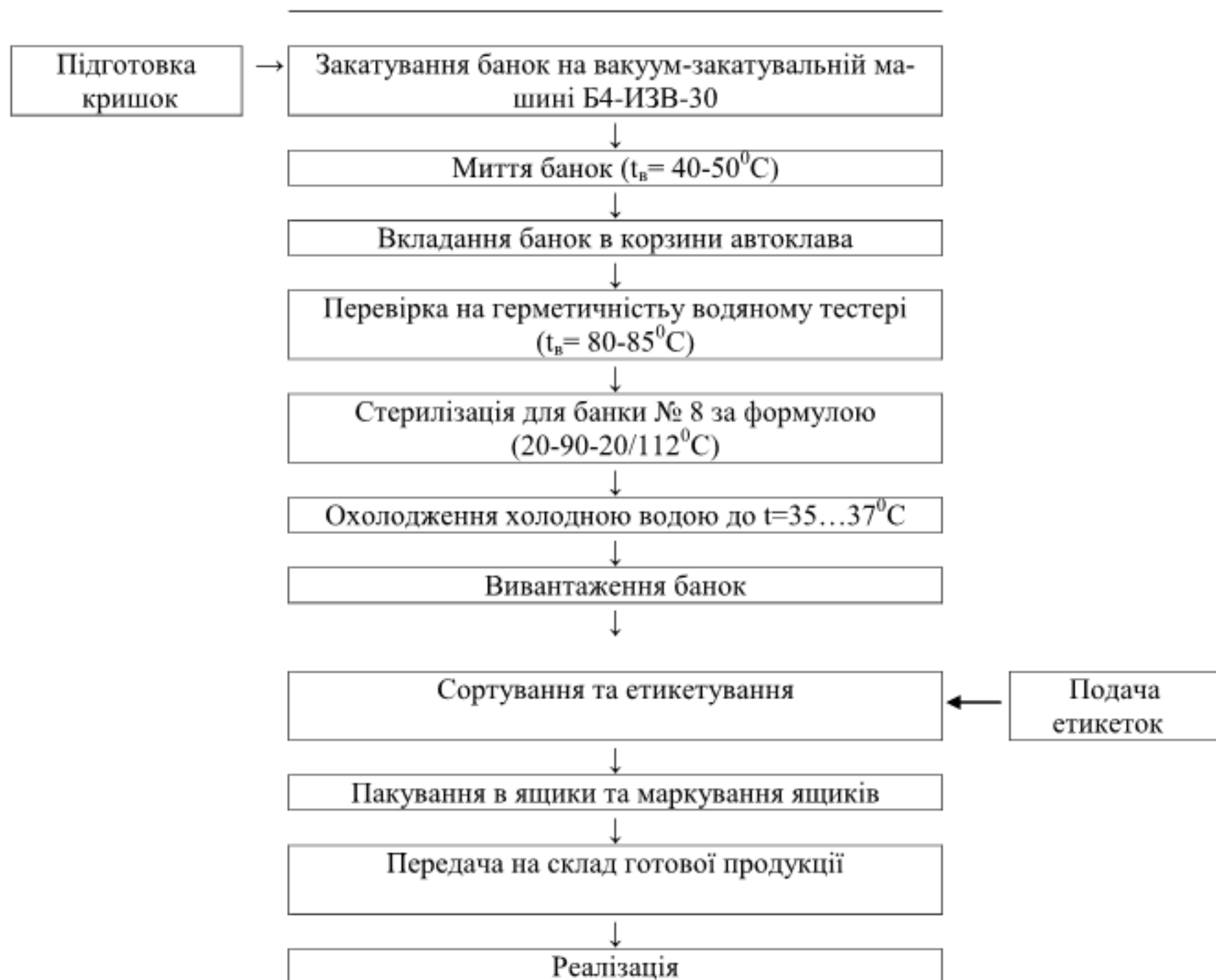
Рис.3 Технологічна схема виготовлення консервів «Паštет печінковий»
