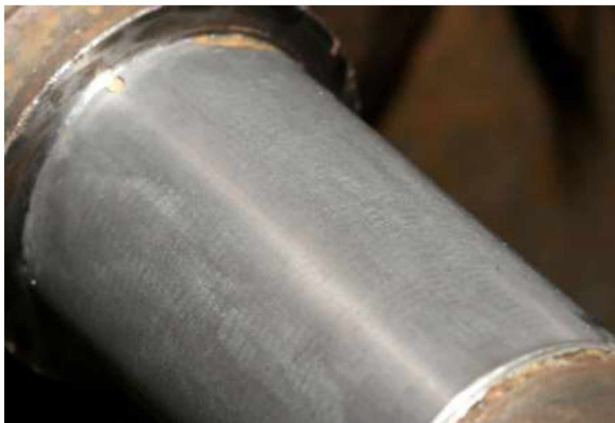
Рисунок 2.8 – Відновлена поверхня валу після шліфування
