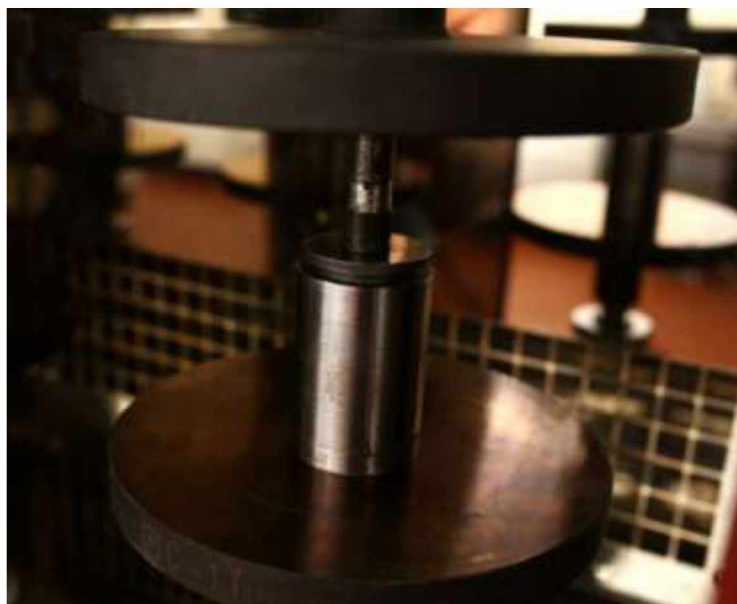
Рисунок 2.1 – Випробувальна оснастка для визначення адгезійних і когезійних характеристик досліджуваних полімерних композицій, встановлена на захватах С-1Т випробувальної машини
