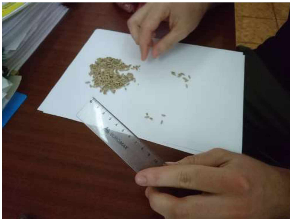
Рисунок 4.4. – Поділ продуктів лущення зерна ячменю
