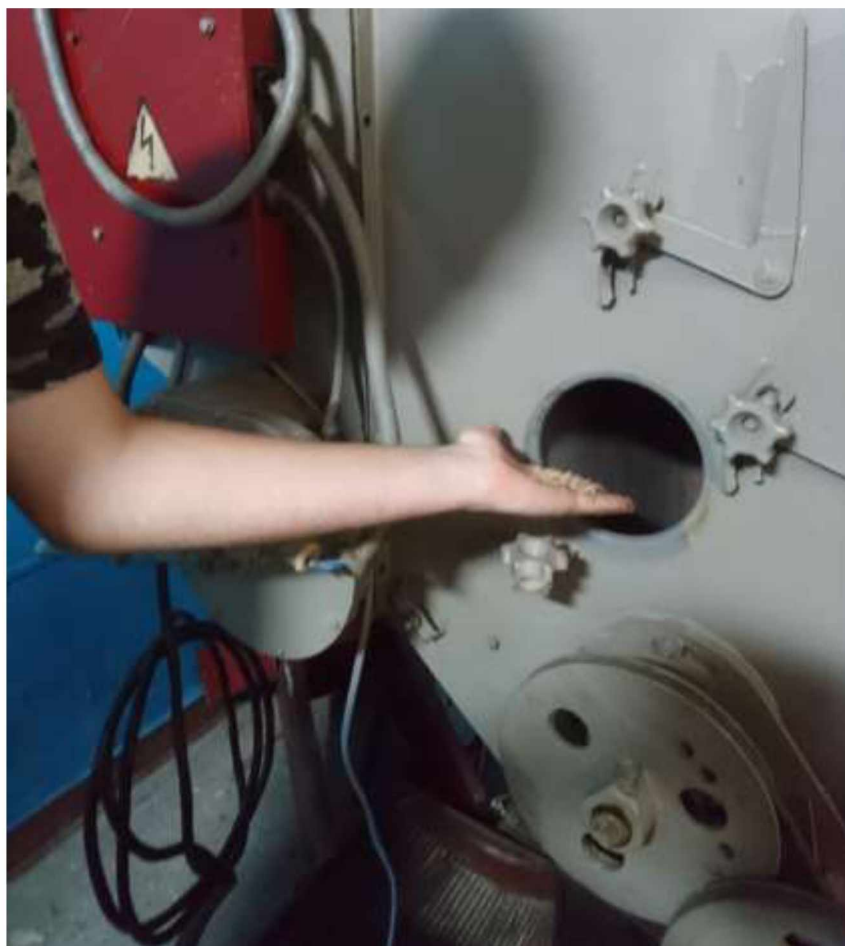
Рисунок 4.3. – Відбір зразків матеріалу під час виробничих випробувань
