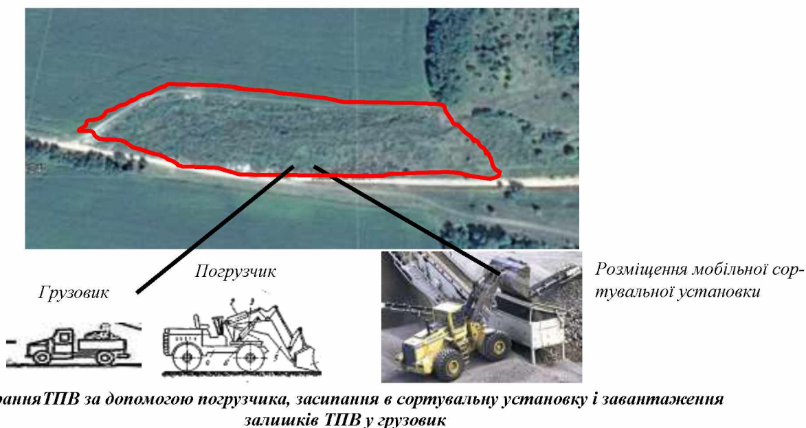
Рис.4.3 – Операції з технічної рекультивації ділянки несанкціонованого звалища
