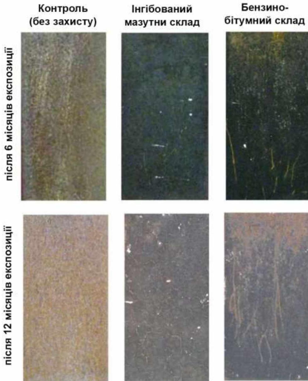
Рисунок 3.8 – Вид пластин після атмосферних випробувань
