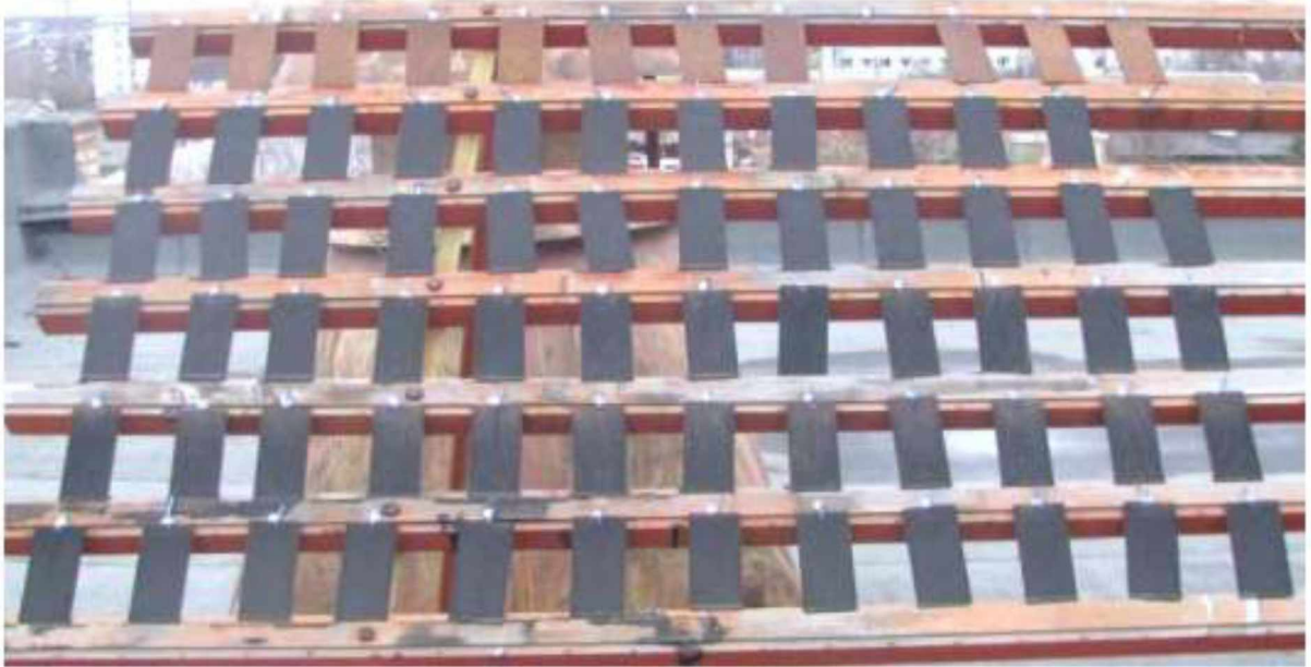
Рисунок 2.1 – Випробування захисних складів на атмосферостійкість
