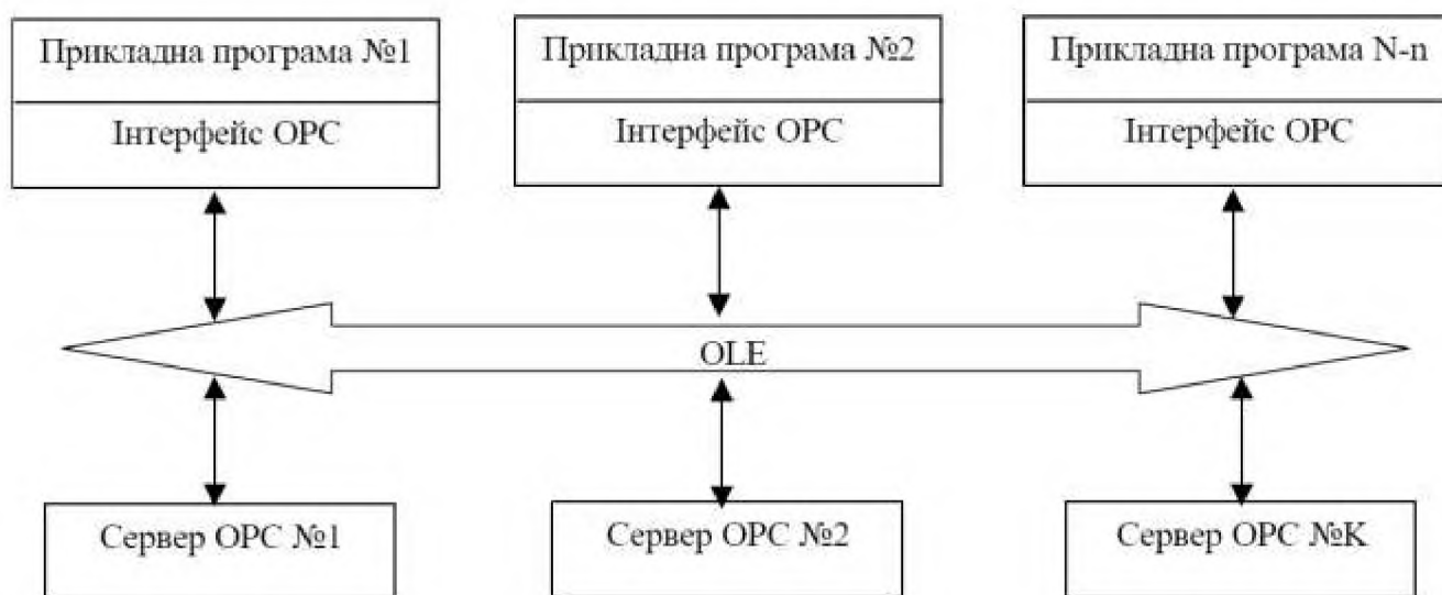
Рисунок 2.3 – Взаємодія прикладних програм з декількома серверами OPC
