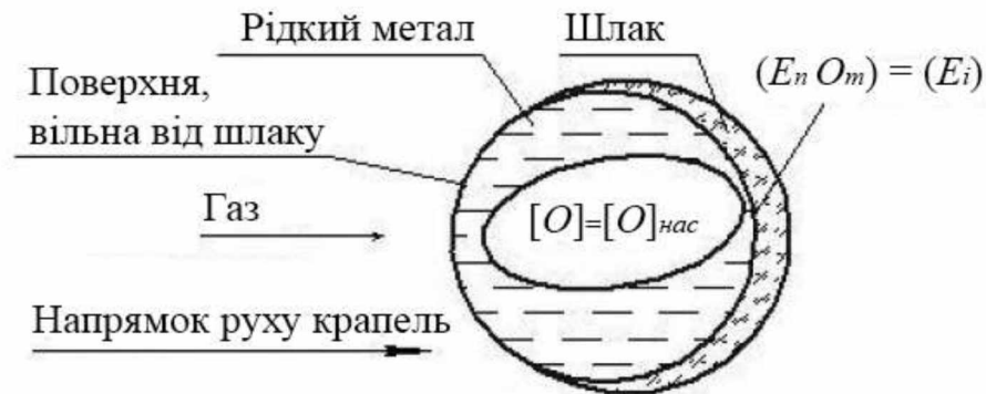
Рисунок 3.3 – Схема надходження кисню в краплю при дуговій металізації
