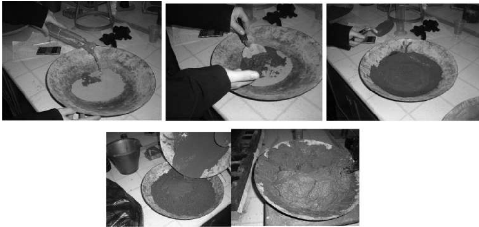
Рис. 2. Виготовлення суміші для дослідних зразків
