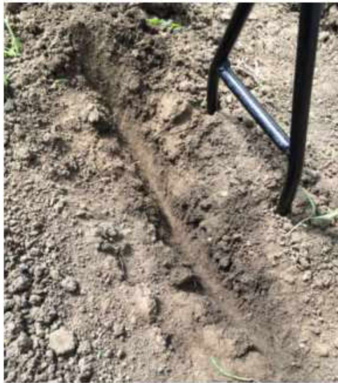
Рисунок 3.5 – Лунка, утворена за один прохід голки
