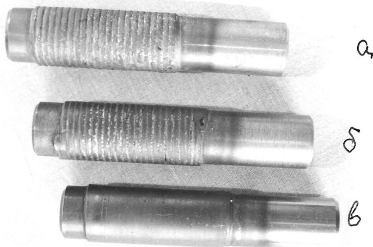
Рисунок 3.3 - Зразки, наплавлені без ТМО, із ВТМО й із НТМО: а - без ТМО; б – із ВТМО; в – із НТМО
