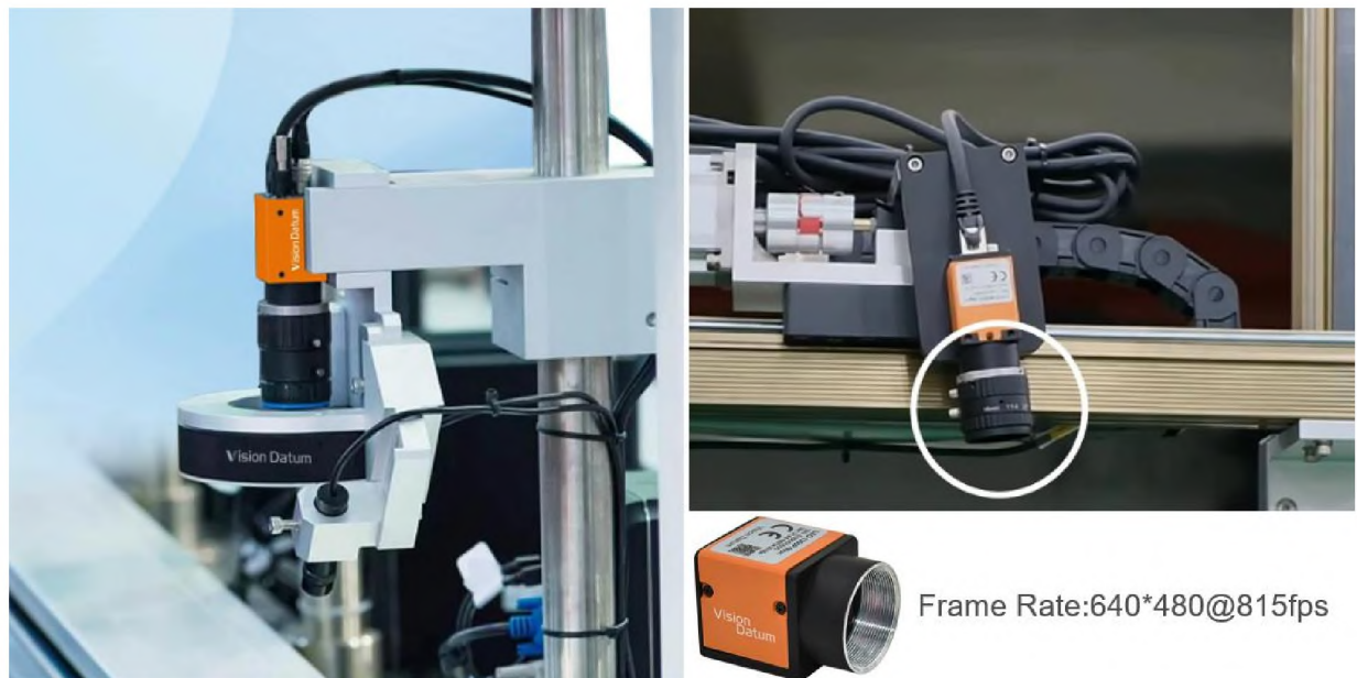
Рисунок 1.3 – Високошвидкісна камера промислового призначення
