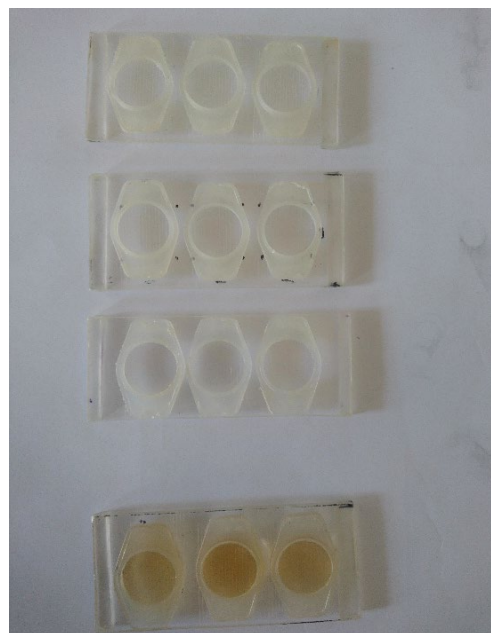
Рис. 3. Лічильна камера для гельмінтоларвоскопічних досліджень
