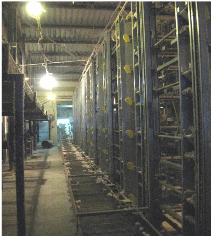
Рис. 3.13. Збирання яєць за допомогою ліфтової системи фірми «Hellmann»
