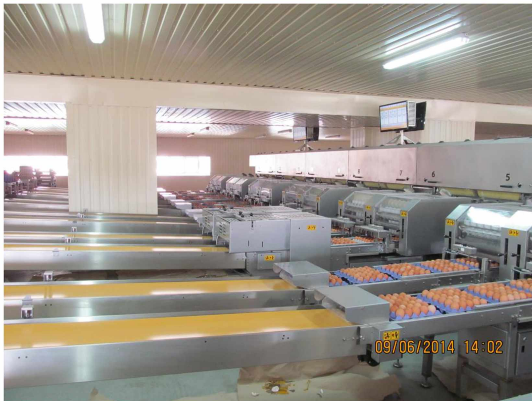
Рис. 3.3. Сучасна яйцесортувальна машина марки «STAALKAT» у ПрАТ «Полтавська птахофабрика»
