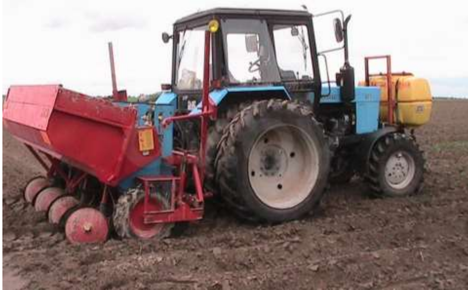
Рисунок 1 – Саджалка з механічним приводом від опорних коліс [3]
