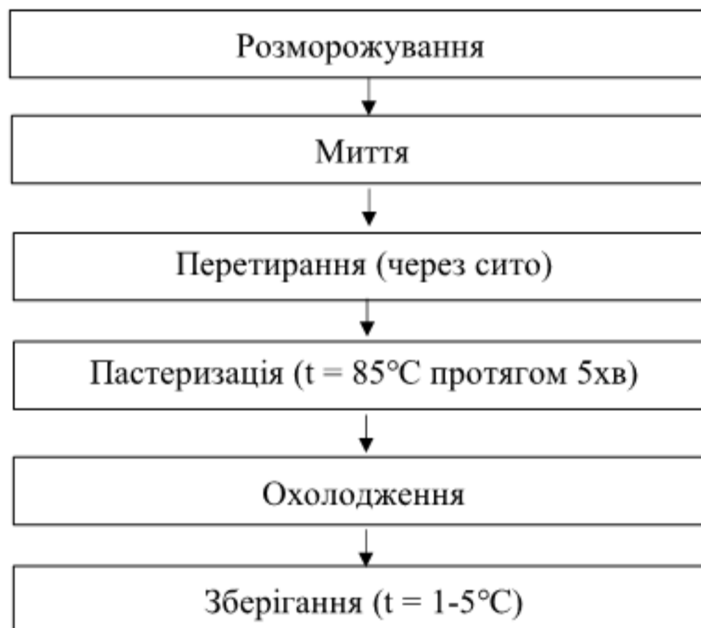
Рисунок 2.4 - Принципова схема приготування соку
