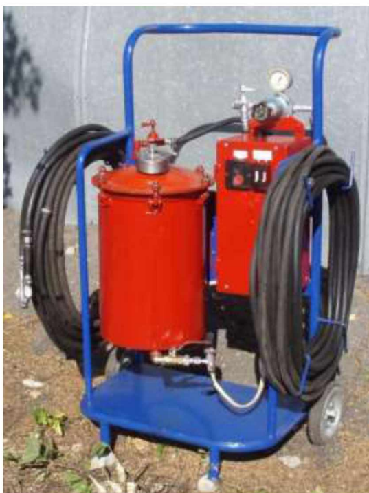
Рисунок 1.4 – Пересувна установка для нанесення загущеній мастила
