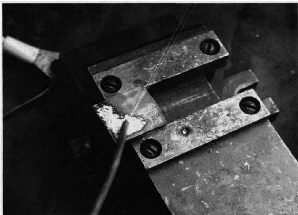
Рисунок 4.3 - Нанесення на поверхню зразка мідного покриття М1
