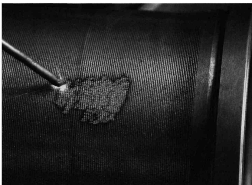
Рисунок 4.6 - Процес нанесення на гільзу покриття М1
