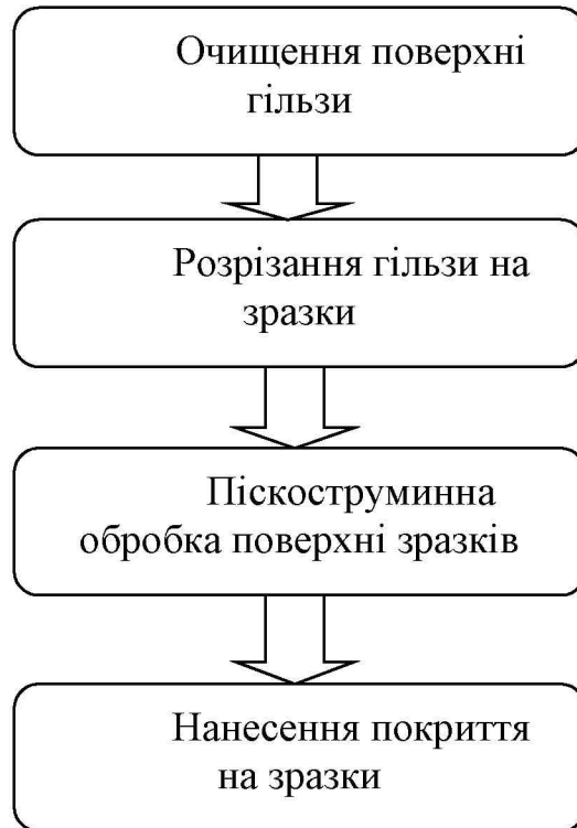
Рисунок 4.2 - Послідовність нанесення покриття методом ЕІО
