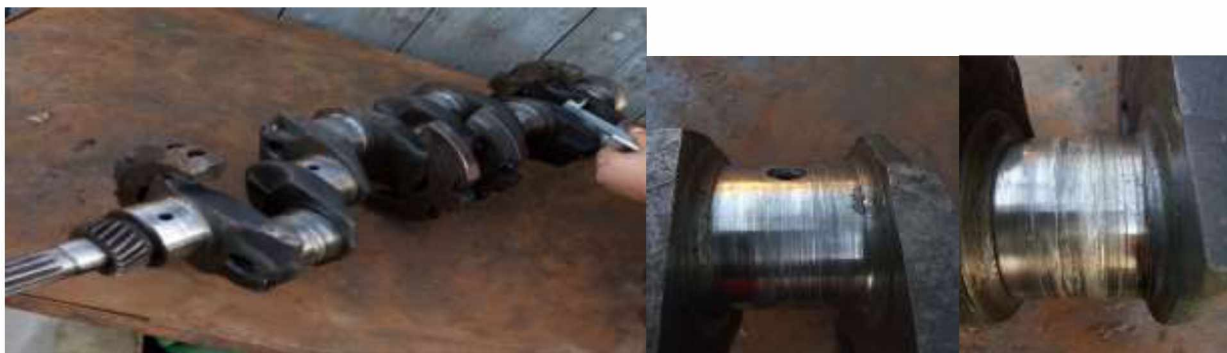
Рисунок 3.1 – Визначення величини зносу шийок колінчастого валу та зношені корінна та шатунна шийки валу
