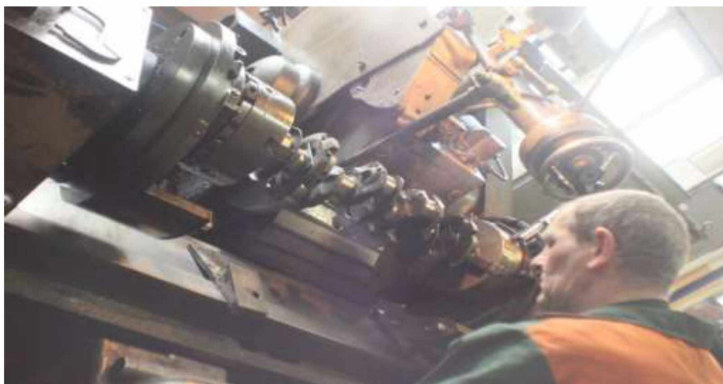
Рисунок 1.3 - Шліфування шийок колінчастого валу
