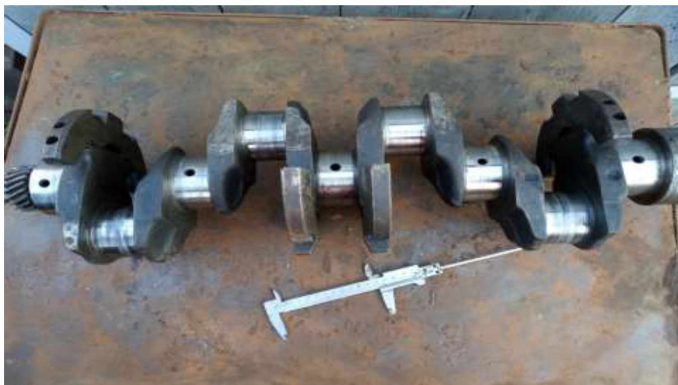
Рисунок 2.1 – Зношений колінчастий вал Д-240
