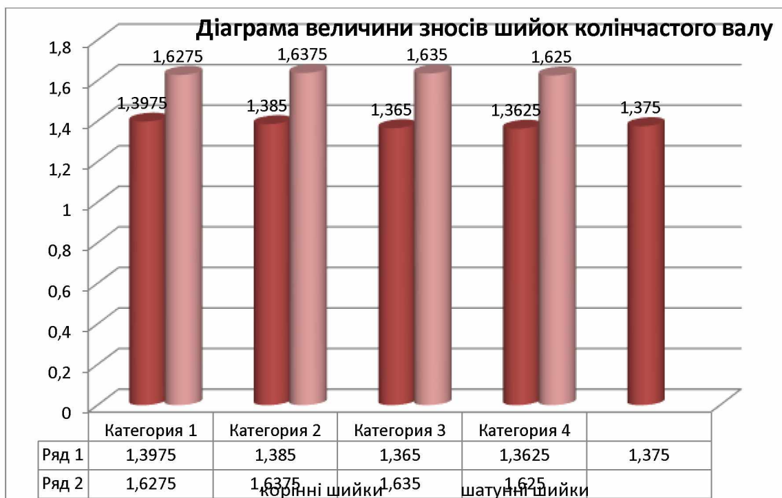
Рисунок 3.2 – Діаграма зносів шийок колінчастого валу
