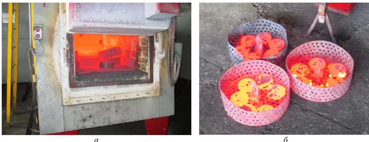
Рис. 3. Термічна обробка в електропечі СНЗ-6,3х13 (а) дослідних зразків (б)
