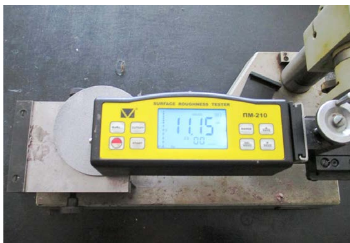
Рис. 4. Визначення шорсткості дослідних зразків
