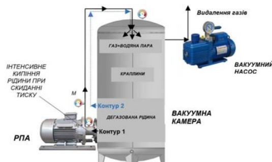
Рисунок 1 – Дослідна установка для дегазації води, де контур 1– цикл дегазації РПА – вакуумна камера; контур 2 – дегазація у вакуумній камері
