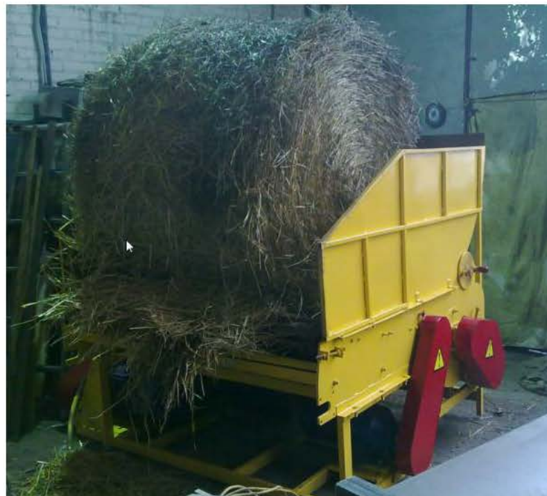
Рисунок 3.1 – Експериментальний зразок модернізованого подрібнювача стеблових кормів
