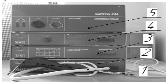
Рис. 1. Загальний вигляд установки «Елітрон – 24А»: 1 – збудник вібрації, 2-4 – накопичувальні блоки, 5 – блок живлення
