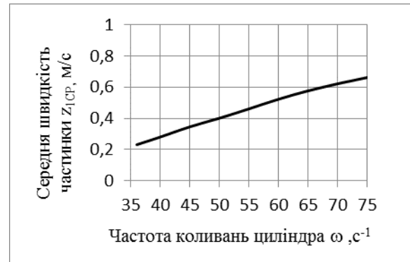
Рис. 5. Залежність 2A від \omega , R = 0,25 м; \Omega = 13 с -1 ; \psi = 0,06 рад; f = 0,35
