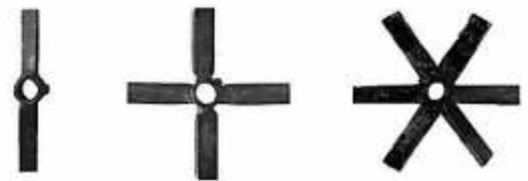
Рисунки 3.2 – Конструкція робочих органів лабораторної дробарки з трапецієподібною формою лопатей та кутом нахилу профілю 90^\circ
