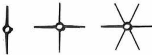
Рисунки 3.1 – Конструкція робочих органів лабораторної дробарки з прямокутною формою лопатей та кутом нахилу профілю 45^\circ
