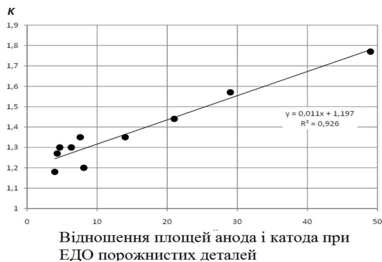
Рисунок 4.8. – Залежність підвищеної мікротвердості армуючого шару порожнистої частини від співвідношення площ анода та катода за нормалізованим ЕДО
