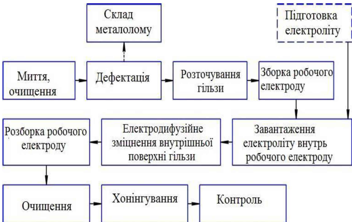
Рисунок 5.1 - Конструктивна схема процесу посиленого ремонту ЕДО внутрішньої поверхні гільзи циліндра
