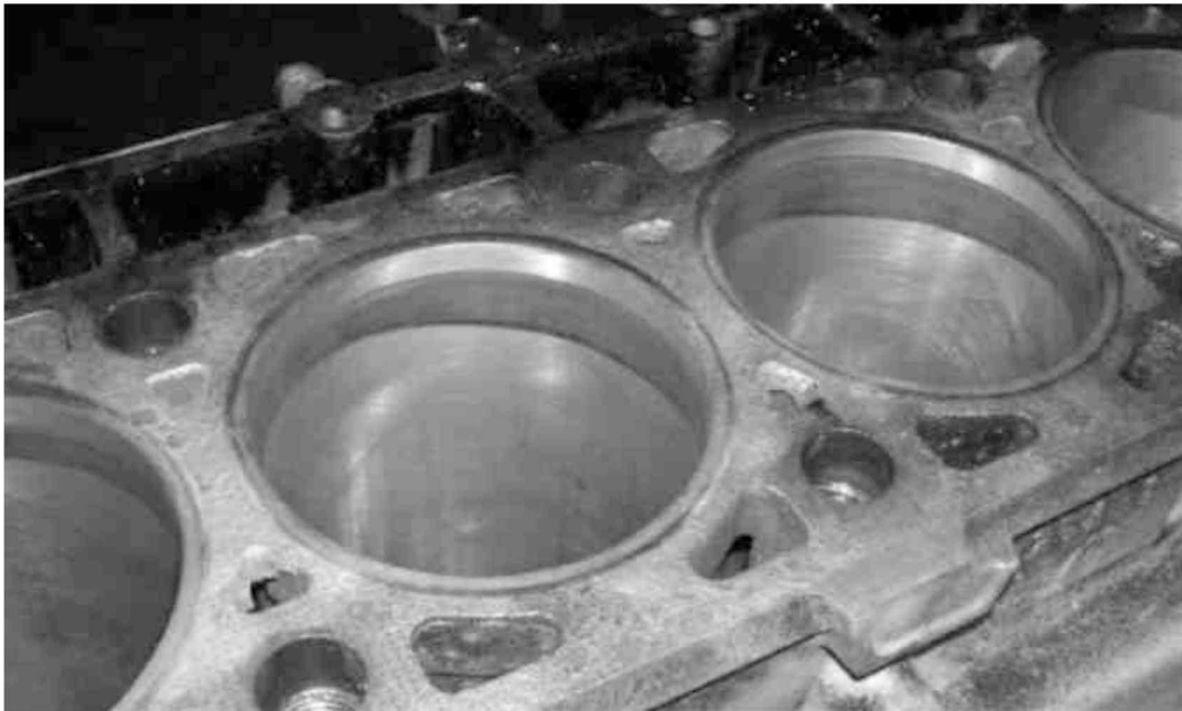
Рисунок 1.2- Зношені гільзи циліндра ДВЗ Caterpillar-3116
