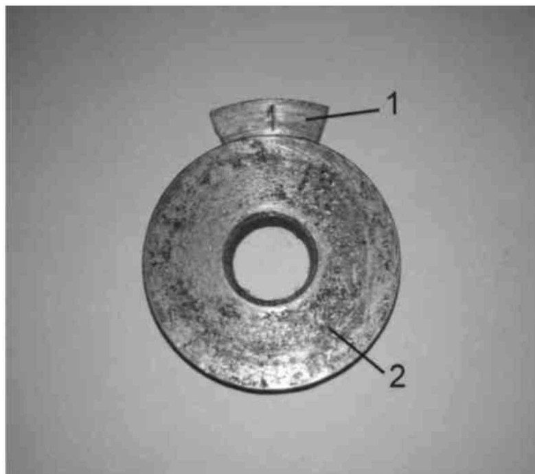
Рисунок 3.6. - План випробування колодок на знос: 1-тестовий зразок, 2-еквівалент.
