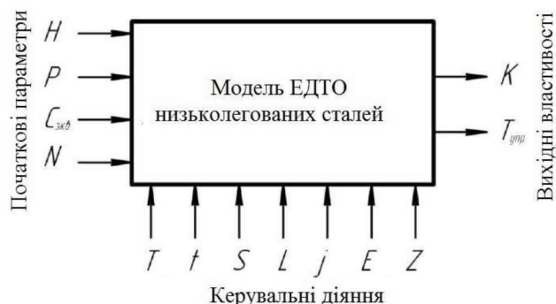
Рисунок 4.7 - Рішення для отримання заданої продуктивності робочої поверхні деталі після ЕДО
