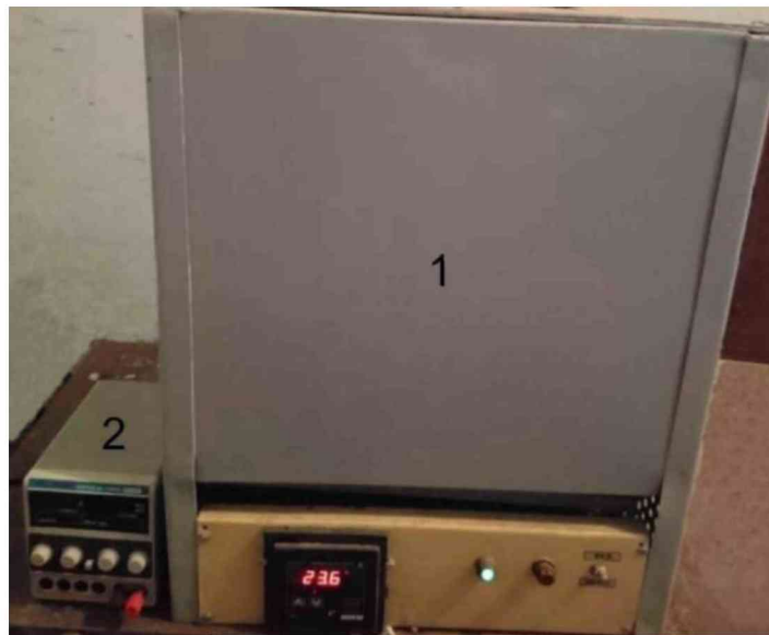
Рисунок 5.5 - Вхідна установка ЕДО: 1 - Електрична шахтна піч СШОЛ-35/11, 2 - Блок живлення постійного струму СУНККОПС-152
