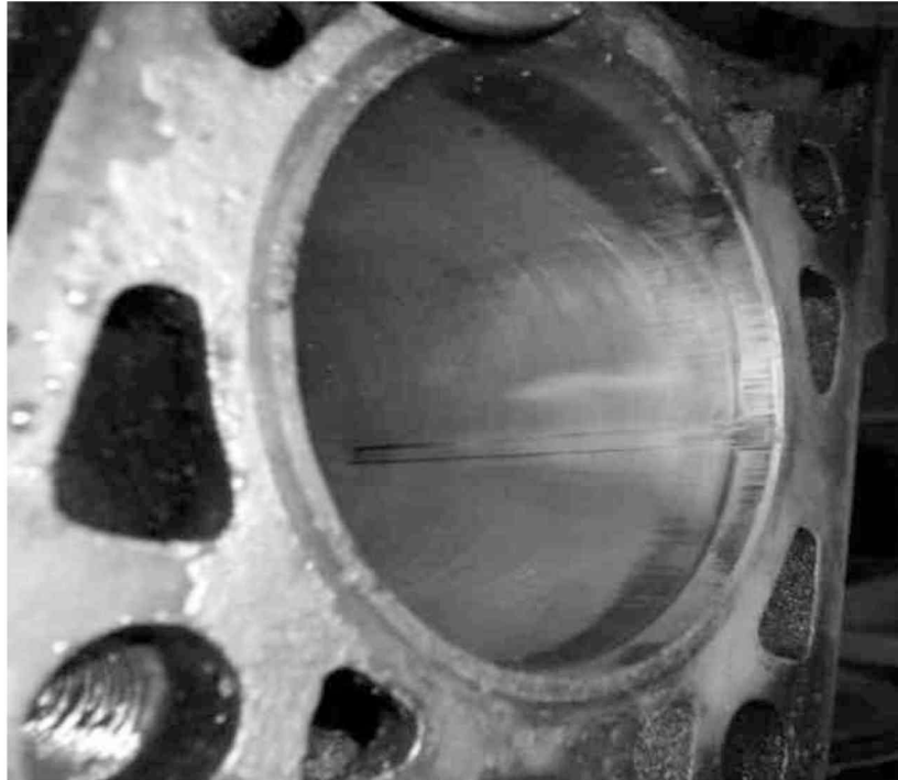
Рисунок 1.3- Задири на гільзах циліндрів двигуна MAN
