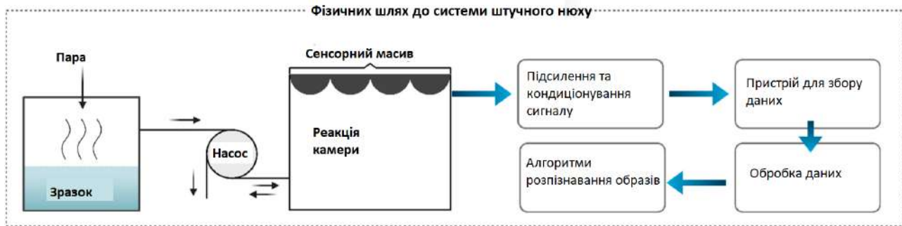
Рис. 7. Схематичне зображення системи штучного нюху (e-nose)
