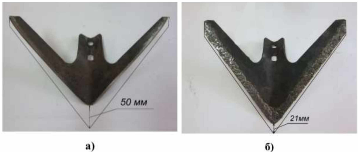
Рисунок 3.8 – Стрілчасті лапи культиватора КШН-12Н: незміцнена (а) після напрацювання 34 га (що досягла граничного стану) і зміцнена КВДЗ з тильного боку (б) після аналогічного напрацювання
