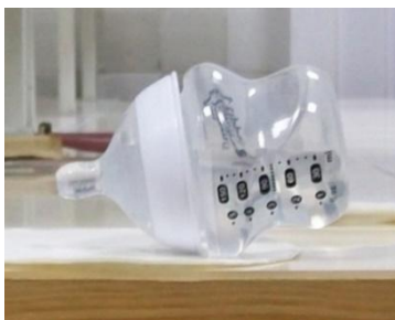
Рис. 12. Фотографічне зображення вимірювання герметичності пляшки для годування Tommee Tipree Closer to nature
