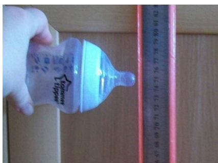
Рис. 13. Фотографічне зображення процесу перевірки міцності на удар пляшки для годування немовлят ТМ Tommee Tipree Closer to nature:
