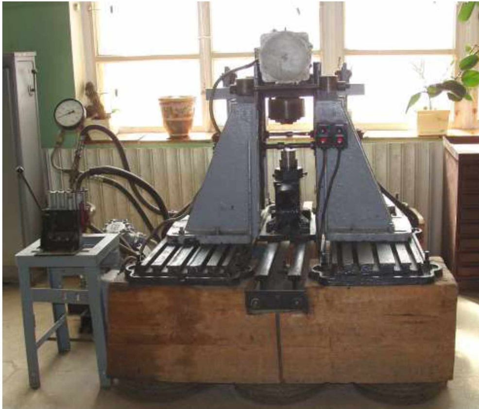
Рис. 2.1. Загальний вид установки: 1 - вібратор; 2 - основа і допоміжне обладнання; 3 - гідравлічна система
