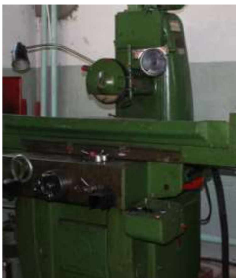
Рисунок 2.4 – Плоскошліфувальний верстат для обробки торців корпусів форсунок
