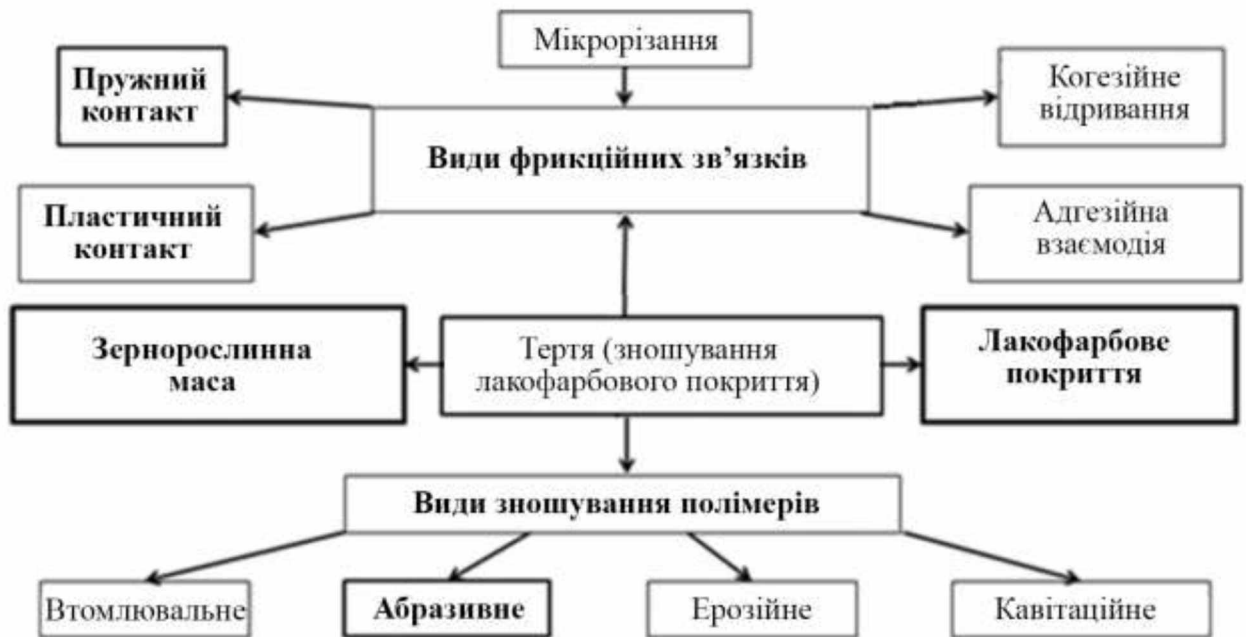
Рисунок 3.4 – Види фрикційних зв'язків і зношування полімерів
