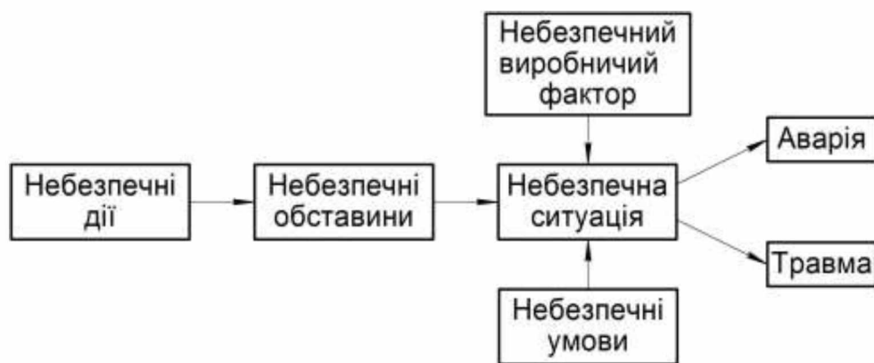
Рисунок 4.1 – Блок-схема формування та виникнення травмонебезпечних аварійних ситуацій
