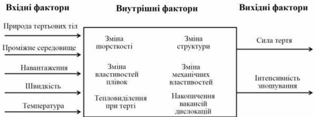
Рисунок 3.1 – Схема факторів, що впливають на фрикційну взаємодію твердих тіл
