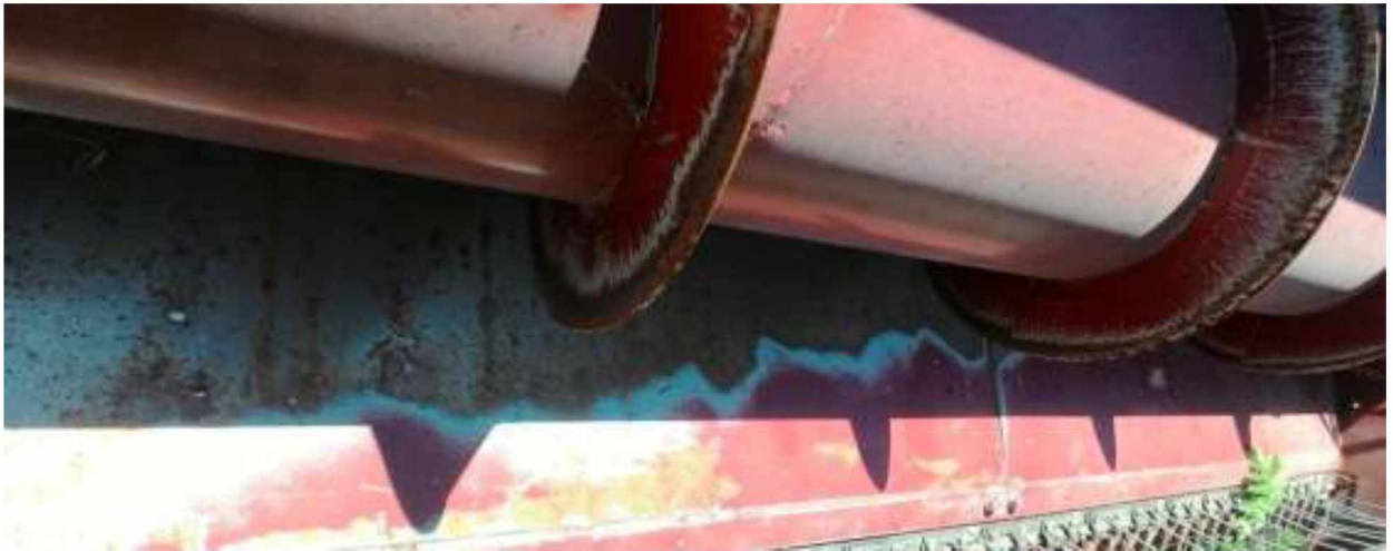
Рисунок 3.3 – Поверхня днища жатки комбайна «Акрос - 530» після двох сезонів роботи
