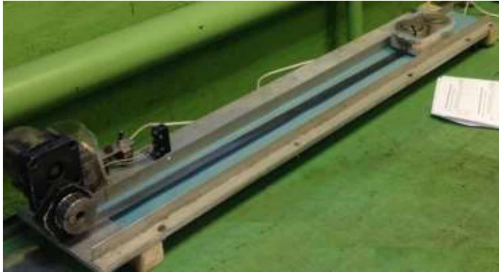
Рисунок 2.3 – Пристрій для визначення опору стирання лакофарбових покриттів
