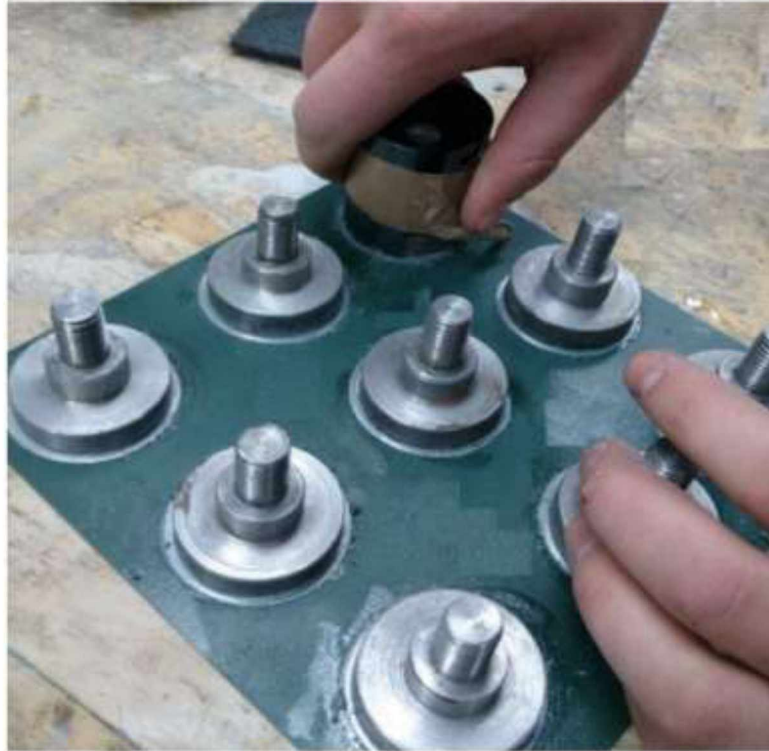
Рисунок 2.3 – Проведення випробувань за визначенням адгезійної міцності лакофарбових покриттів
