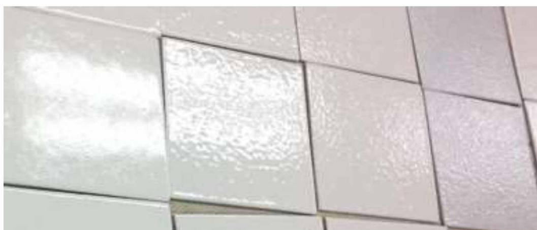
Рисунок 2.5 – Шорсткість лакофарбового покриття в залежності від додавання розчинника до складу лакофарбового матеріалу
