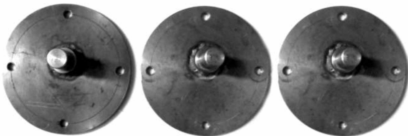
Рисунок 2.2 – Набір змінних ексцентриків
