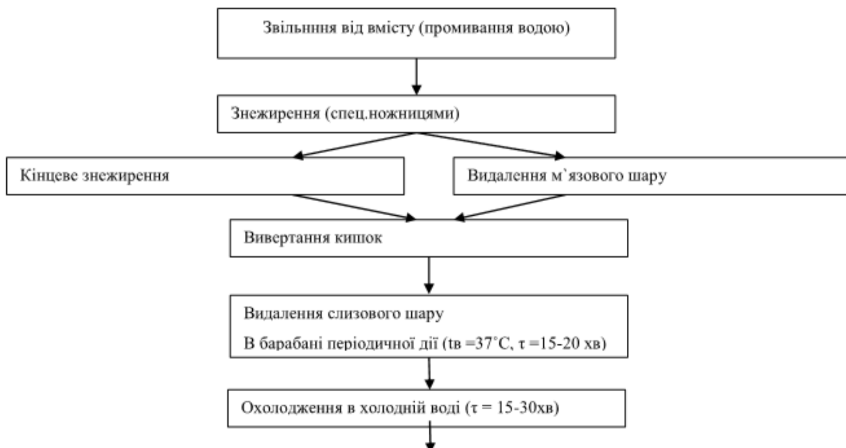
Рис.1.12. Технологічна схема обробки кругів, синюг, прохідників ВРХ
