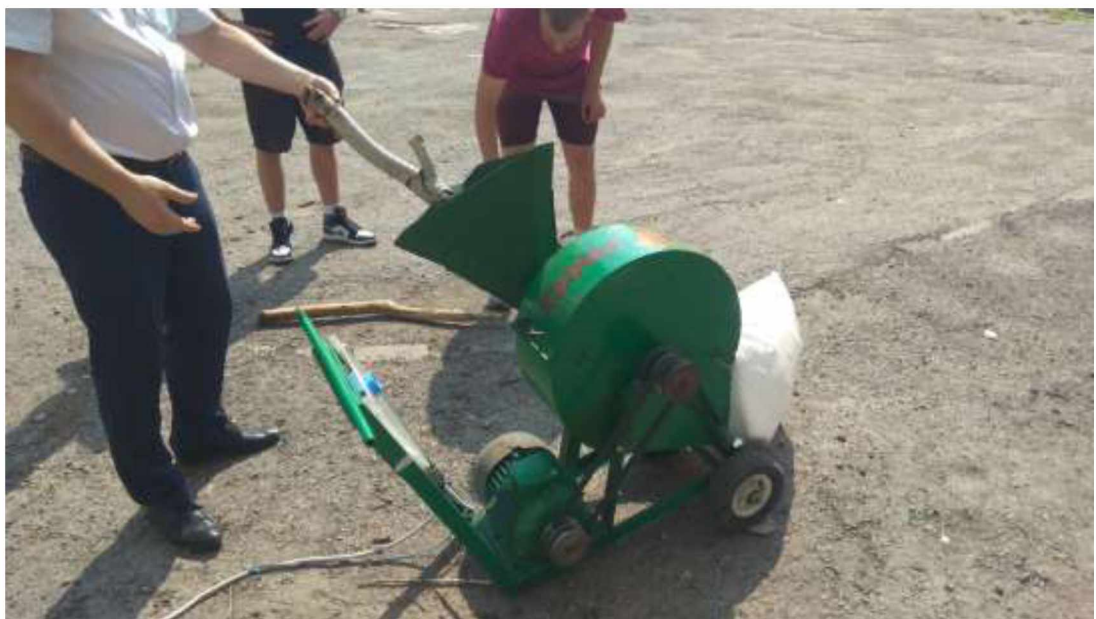
Рисунок 3.3. – Проведення експерименту на малогабаритному подрібнювачі гілок
