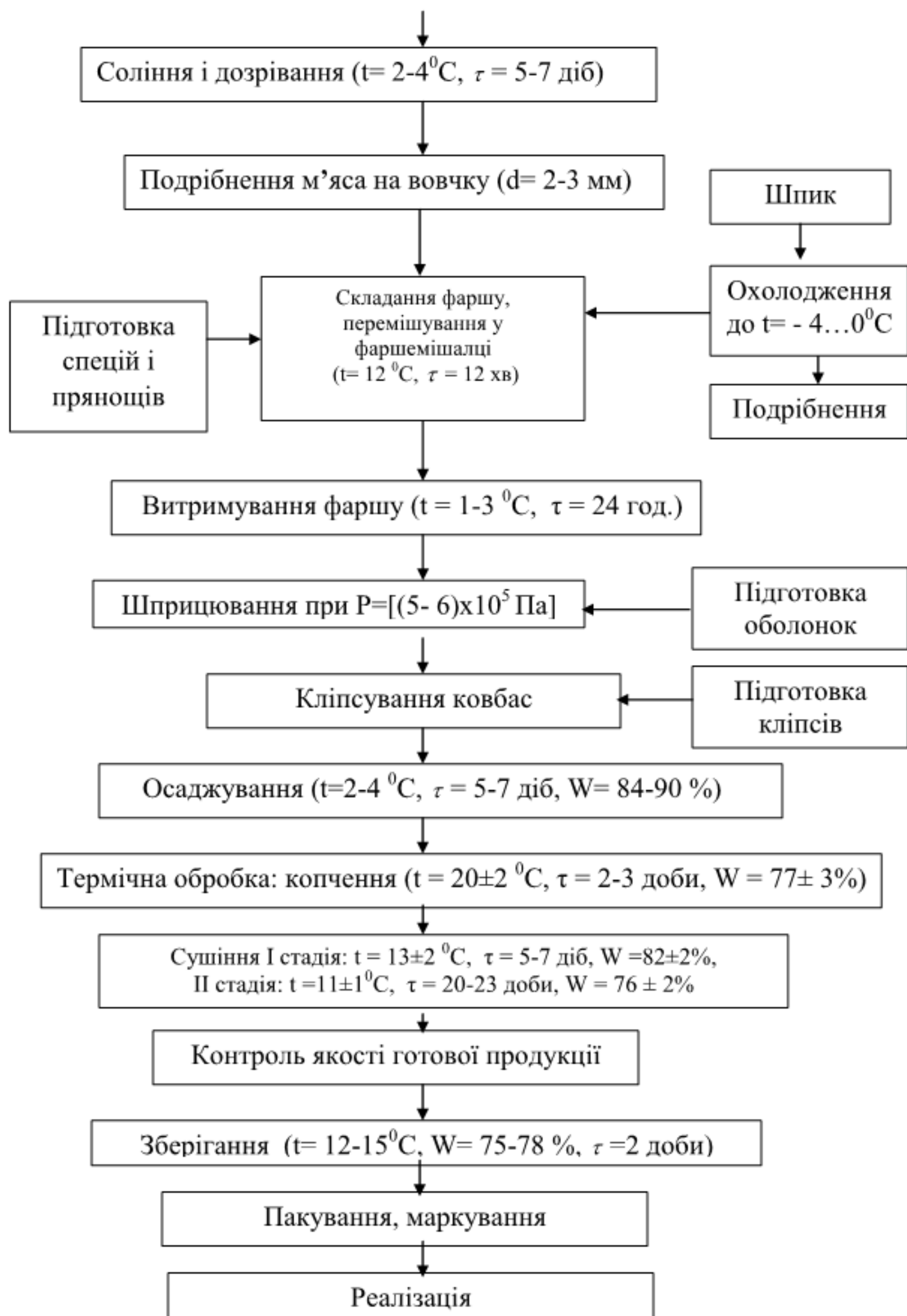
Рисунок 1.1 - Технологічна схема виробництва сирокопчених ковбас (див. додаток А)
