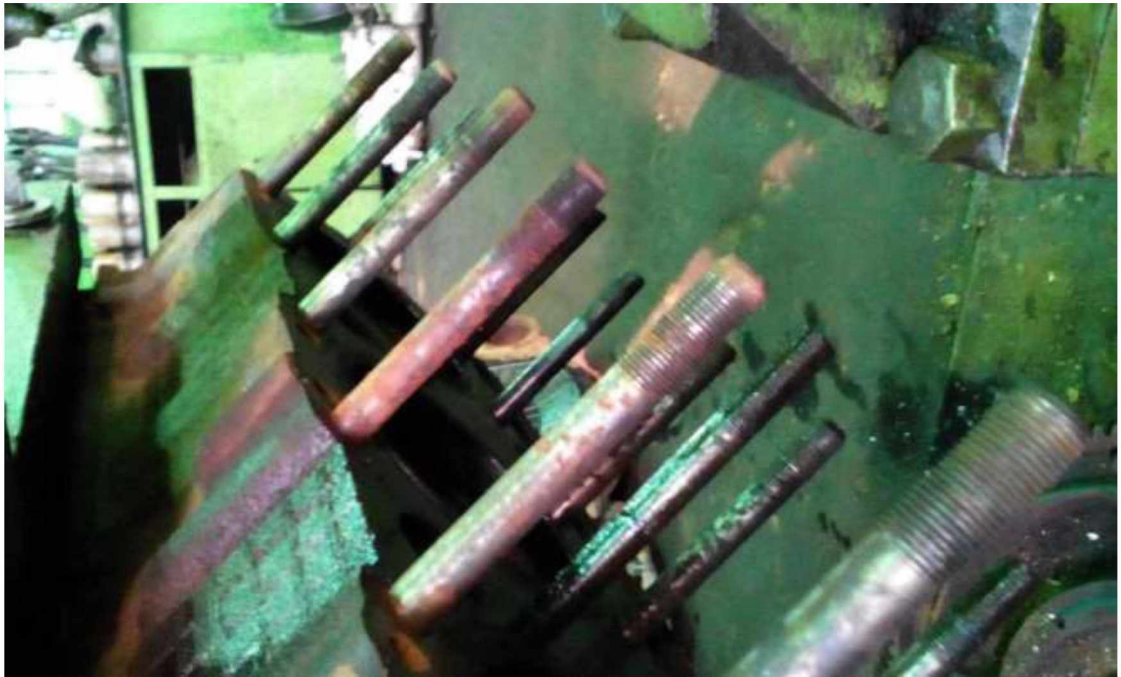
Рисунок 1,3 - Шпильки ГБЦ перед складанням двигуна ЯМЗ-238
