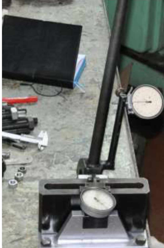
Рисунок 2.2 - Схема вимірювання сили натяжки
