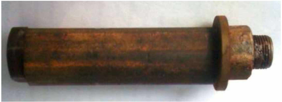
Рисунок 2.3 - Різьбова пара в процесі кородування
