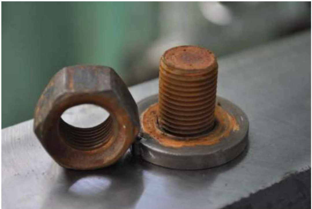
Рисунок 2.4 - Різьбова пара після кородування розчином азотної кислоти
