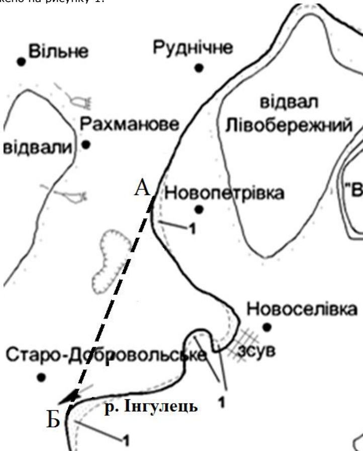
Рисунок 1. Зони підвищеної концентрації забруднених наносів по руслу р. Інгулець та місця накопичення техногенного алювію і можливе штучне випрямлення річки з пункту А в пункт Б
